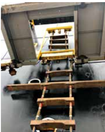
Figura 5. PBA conforme apresentado: escada de quebra-peito apresentada em duas seções. Ambas as seções são fixadas exclusivamente à plataforma da escada de portaló, em vez de serem fixadas ao navio. As seções do quadro horizontal amarelo estão impedindo o acesso durante a subida ou descida.
