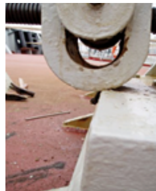
Figura 8 – Regulagem incorreta do freio
