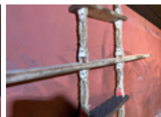
▲ Figura 6 – Segunda escada, rejeitada pelos chicotes entre os degraus estarem muito solecados
