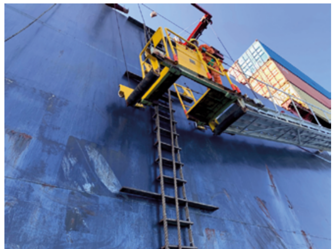
Figure 4 – isang sumusunod na combination PBA na may trap door – ang pilot ladder at man ropes ay umaabot pataas at ginawang nakakapit sa deck ng barko.
