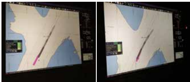
PPU na nagpapakita ng GPS smoothing (sa itaas) na may vessel “lagging” at smoothing removed (sa ilalim)
